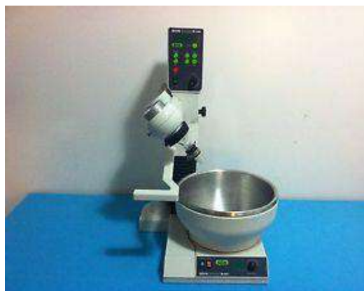
სურათი 4. 108. სხვადასხვა კონსტრუქციის როტაციული ამორთქლებლები
