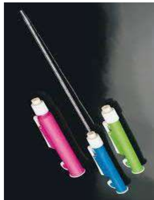
სურათი 4. 84. პიპეტებში ნივთიერების ამოსატუმბი მოწყობილობა
