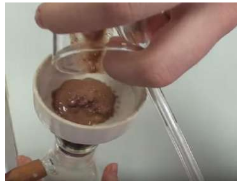
სურათი 4. 96. გასაფილტრი ნარევის გადატანა ფილტრზე.
