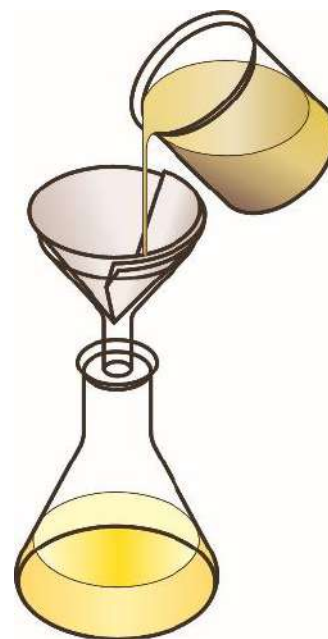
სურათი 4. 111. ნარევის ცხლად გაფილტვრა
