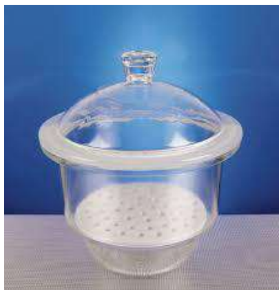
სურათი 4. 68. ექსიკატორები: ა) უონკანო; ბ) ონკანიანი
