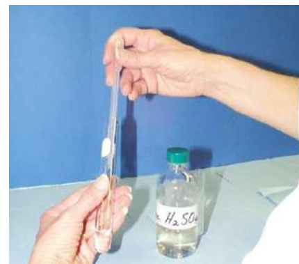
სურათი 4. 69. გოგირდმჟავას სიმკვრივის დადგენა
