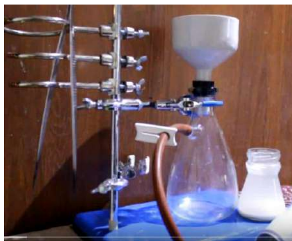
სურათი 4. 97. ვაკუუმ-ფილტრაციის მოწყობილობა. 1. ბიუნზერის ძაბრი; 2. დამცავი გარსაცმი; 3. ბუნზენის კოლბა; 4. დამცავი ჭურჭელი; 5. წყალჭავლური ტუმბო
