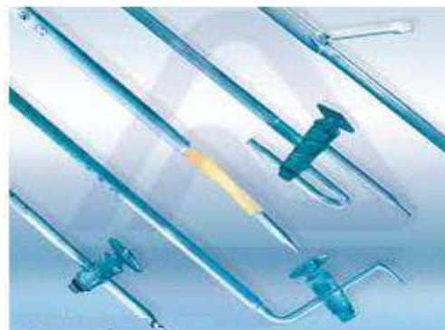
სურათი 4. 79. ონკანიანი და უონკანო ბიურეტები
