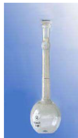
სურათი 4. 56. პიკნომეტრით სიმკვრივის განსაზღვრა
