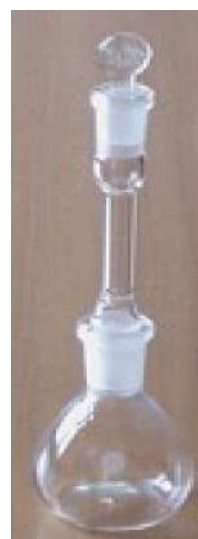
სურათი 4. 56. პიკნომეტრით სიმკვრივის განსაზღვრა
